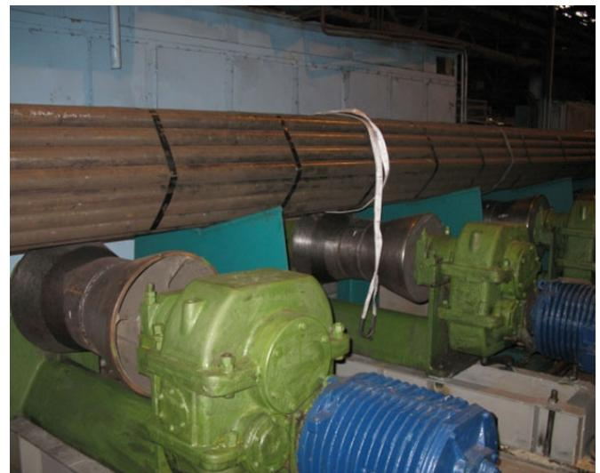
Учитывая, что большинство весов используется в существующих линиях и зачастую нет возможности встраивать весы в рольганг, а также требования заказчиков — проведение монтажных работ, не останавливая производство, мы можем разработать весы ВРТ «ПОРТАЛ» без вмешательства в конструкцию рольганга.
