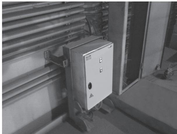
Фото 1. Размещение шкафа измерительного на мосту крана
